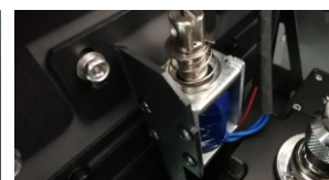
Avtomatski detektor višine, tudi do 100 mm substratov
