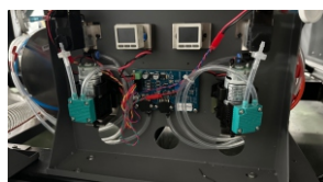
Gntek sistem za kroženje bele barve ter Sistem negativni pritiska
